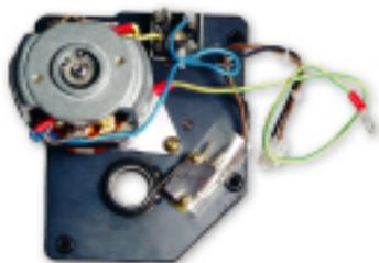
独特的马达/齿轮箱是为配合M-PACT断路器的操作而专门设计的。仅用三个螺栓便能安装定位。当断路器闭合时，此单元会自动再次使操作机构处于储能状态，以便需要时再次迅速闭合断路器。机构储能可在3秒钟内即可完成。
