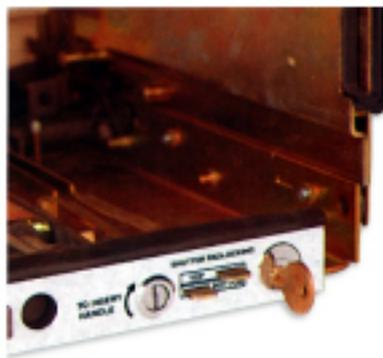
此装置只适用于抽出式断路器。这个系统通过钥匙将断路器锁定在断开位置。当钥匙取下时，安全挡板位置自动锁定，防止了接触触头，同时无法操作推进机构。
