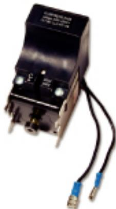
合闸线圈能现场或远程操作合闸断路器。它内附的防重合闸系统有效地达到了每一个信号只能使断路器闭合一次的要求。如果闭合信号被维持时，该系统会自动阻止再次闭合操作。该装置设计为卡口式安装，方便装卸，无需紧固件。它设计有动作指示针，能直观动作与否。
