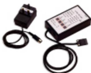
通过注入二次侧电流，从而验证每相MCR与HSISC保护的可靠性。该测试单元亦用于验证过电流及接地故障的起动作值。也可用于检查脱扣以证实微处理机操作的效率。该测试单元配有一个充电电池和一个标准充电器。
