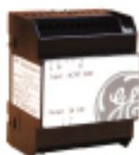
可置于开关柜内确保M-PRO一直接收到独立连续的电源。输入电压有380VAC、110,220V AC/DC的输入都将被接收。最大输入电流是0.5A。最大输出电压是24V DC。
