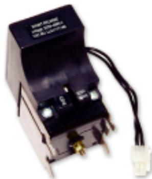
分励脱扣器能现场或远程迅速分断断路器。它的控制线与断路器的辅助接点串接，确保了断路器的安全操作。该装置设计为卡口式安装，方便装卸，无需紧固件。它设计有动作指示针，能直观它的动作与否。
