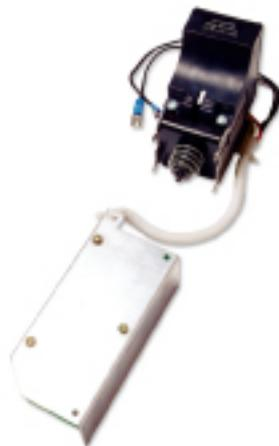
当电源电压低于要求值的时候，欠压瞬时脱扣器能迅速断开断路器。形状相同的欠压延时脱扣器当电压低于要求值的时候，它能够在设定的延时时间内保证断路器不脱扣。延时时间为 $3\text{sec} \pm 1\text{sec}$ 。该装置设计为卡口式安装，方便装卸，无需紧固件。它设计有动作指示针，能直观动作与否。
